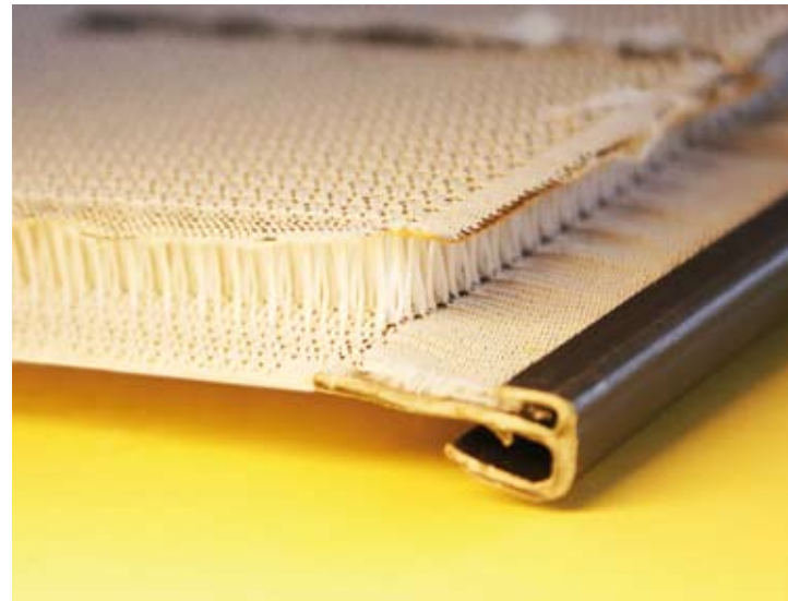
3 D-Gewebe Bild, 20mm, der Polfaden als Kettfaden zwischen den Deckflächen. Die geschwungene Form zwischen den beiden Gewebeseiten wird sichtbar.
